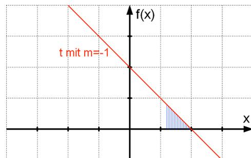
Das heisst: Wir suchen alle Stellen  $x_0$  in denen die Tangentensteigung im Kurvenpunkt  $(x_0 / f(x_0))$  1, oder -1 beträgt. Zu lösen ist somit die Gleichung:  $f'(x_0) = \pm 1$ :
